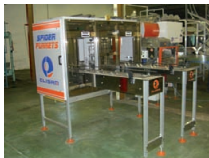
Destacker for Wooden Punnets: Spider Punnets Disimpilatore Cestini in Legno: Spider Punnets
